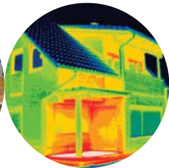
Термокамерите помагат за намиране и оценка на термичните загуби на сградата.
